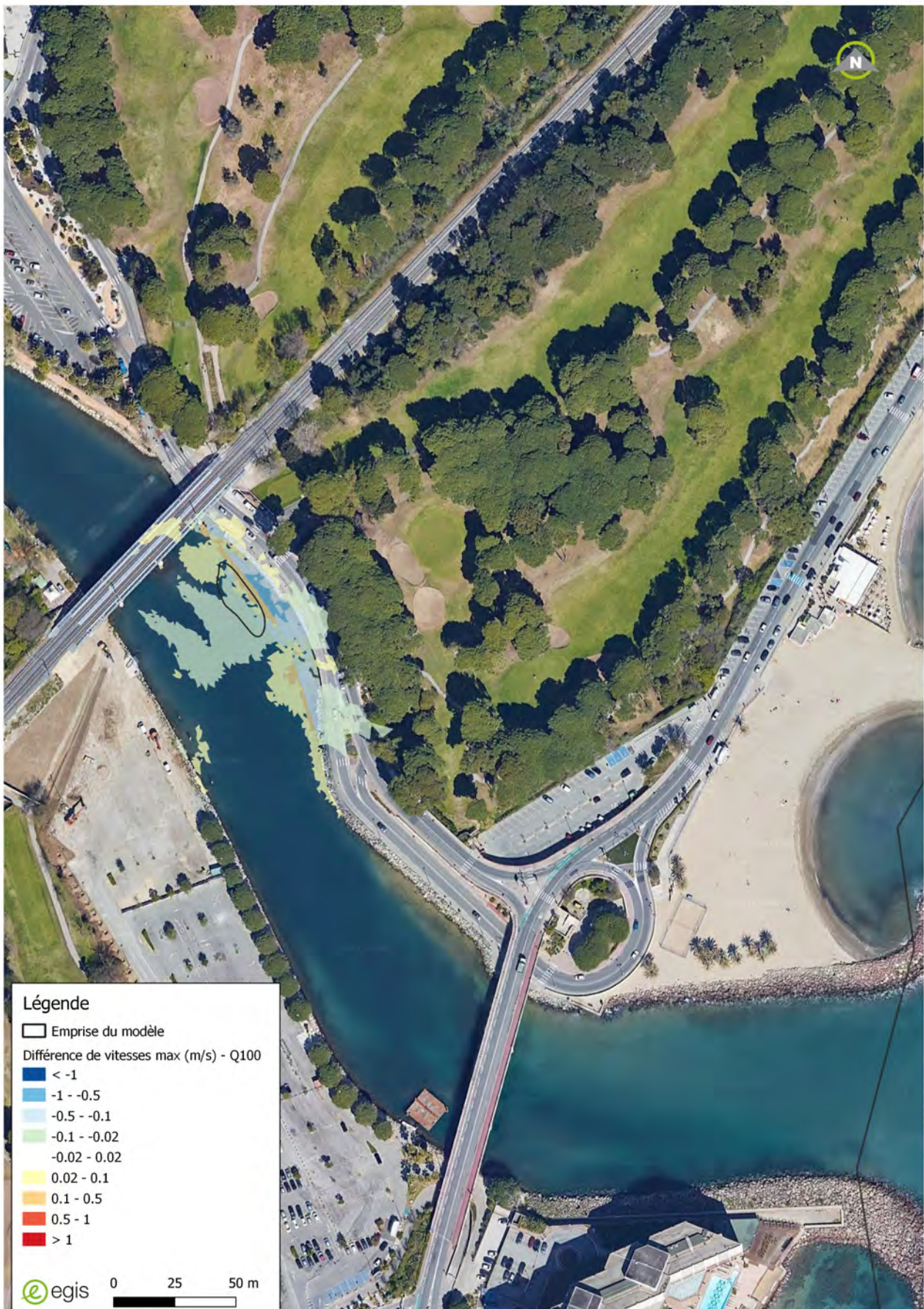
FIGURE 7 : CARTOGRAPHIE D'IMPACT DES VITESSES D'ÉCOULEMENT AVANT/ APRES TRAVAUX POUR LA Q100 (ZOOM ENTRE LES 2 PONTS)
